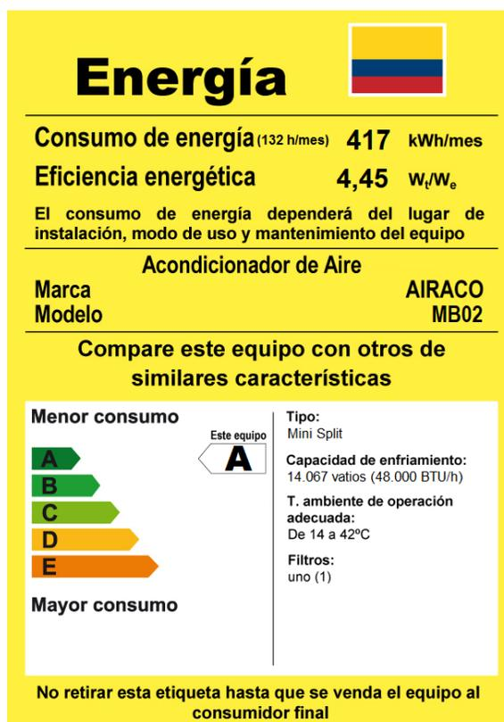
Figura 8.5. Ejemplo de etiqueta para Acondicionadores de Aire desde 10.540 y hasta 17.580 W de capacidad de enfriamiento <sup>90 91</sup>
