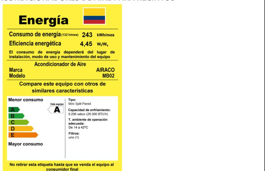
Figura 7.5. Ejemplo de etiqueta para Acondicionadores de Aire hasta 10.540 W de capacidad de enfriamiento.<sup>65</sup> <sup>66</sup>
